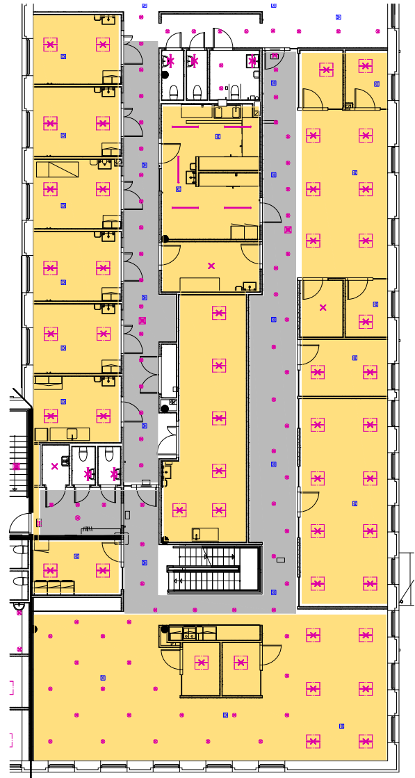
Ett exempel på våningsplan där armaturer är inritade med röd färg. Närvaro- respektive ljussensorer är inritade med blå färg.
