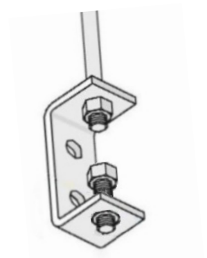
Exempel med ett U-beslag som upphängningsanordning. Beslaget monteras på ovansidan av donlådan med skruv (M8x16).
