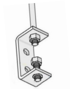
Eksempel med en U-beslag som ophængsanordning. Beslaget monteres på toppen af armaturboksen med en skrue (M8x16).
